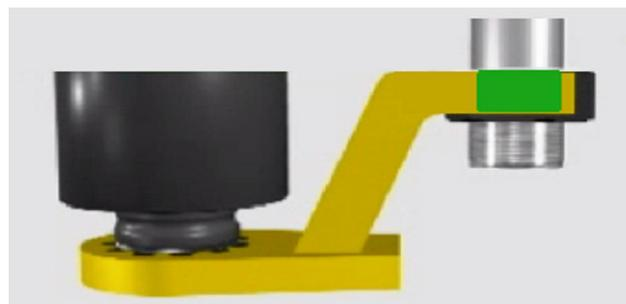
图 4.1.4-1: 正确的反作用力点
