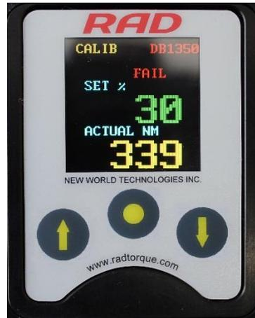
图3.3.12-4: 校准屏幕-实际扭矩值被选定
