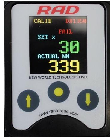
图3.12-4: 校准屏幕—实际扭矩值被选定
