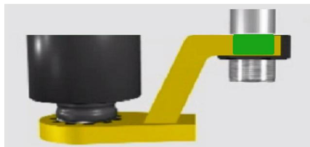
图 4.1.4-1: 正确的反作用力点
